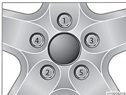
Fig. 90 Serrer en croix les écrous ou les boulons de roue
