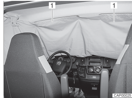
Fig. 15 Dispositif occultant de la cabine de conduite sur le pare-brise
