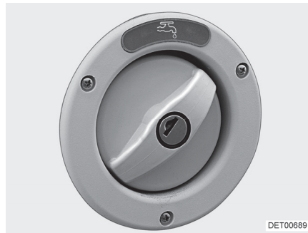
Kuva 70 Juomavesisäiliön täyttöaukon korkki
